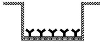
图1. 预包被IgG4抗体微孔板 孔板上预包被了抗人IgG4特异性抗体。
